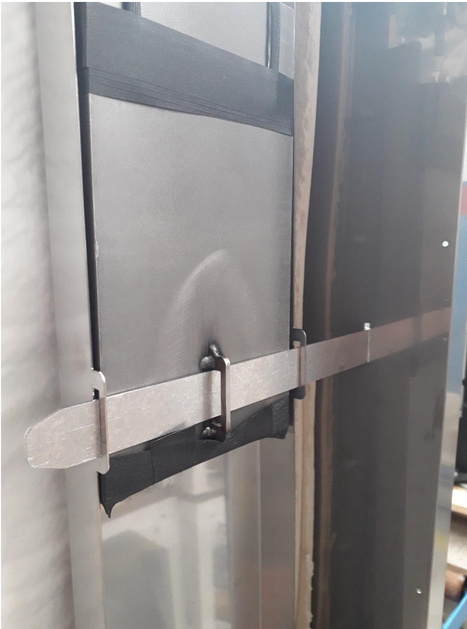
Blocco di sicurezza inserito (vista interna)
